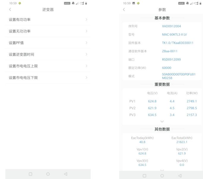
4>数据界面：查看该逆变器的PV功率、PV电压、PV电流、R相功率、S相功率、T相功率以及输出功率，并可通过上滑查看详细的监控数据。
