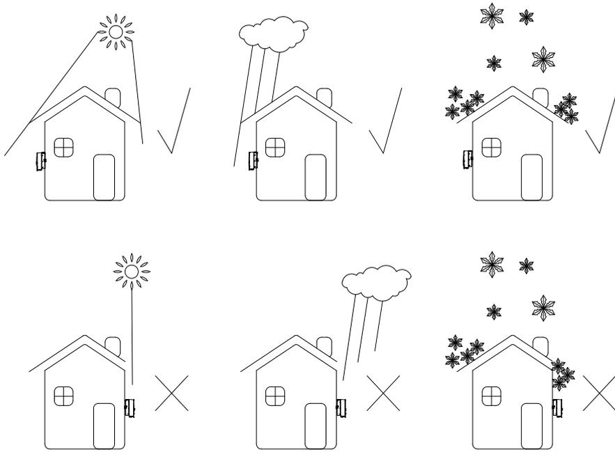
➤ 确保把逆变器安装在一个合适的地方，禁止安装于封闭的箱体内部。
