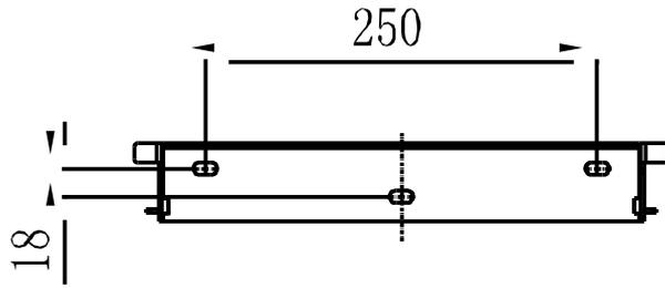
如图所示固定安装支架。不要让螺丝与墙壁齐平。相反，暴露 2 至 4 毫米。
