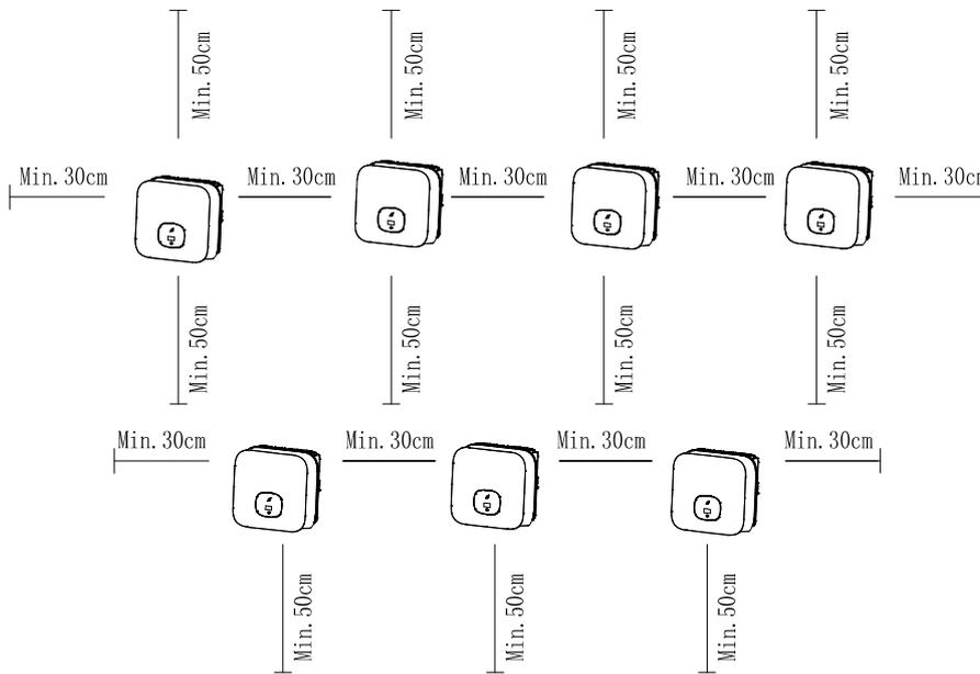
多台逆变器时的安装尺寸
