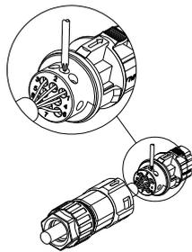
2. 将螺纹套管推入插座，拧紧防水格兰头。
