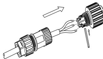
4. 将线束套筒连接接线端子, 然后拧紧锁紧螺母。
